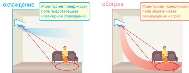
Охлажденный воздух опускается в нижнюю зону помещения, вызывая её чрезмерное охлаждение. Датчик I SEE контролирует температуру поверхности пола и при достижении целевого значения уменьшает мощность кондиционера, предотвращая переохлаждение.
